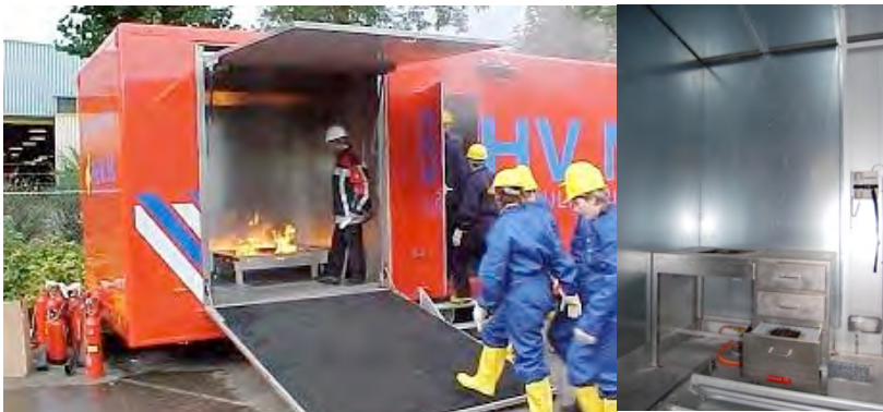
Oplegger voor BHV trainingen. Voorzien van diverse geïsoleerde wanden, wenteltrappen en deuren. Geheel ingericht conform klantwens.
