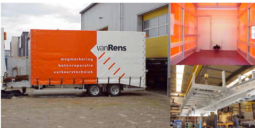
CE middenasaanhangwagen met vangmuil en afgeschuinde vloer voor speciaal transport.
