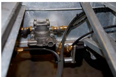
Lastafhankelijk remdrukregelventiel goed bereikbaar. Alle opleggers worden voorzien van een lastafhankelijk remdruksysteem en ABS/EBS voor optimale veiligheid.
