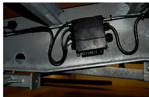
Slagwater dichte centraaldozen zorgen voor overzichtelijkheid in aansluitingen en bedrading.
