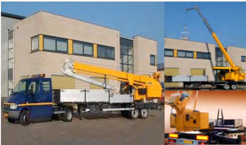
BE oplegger met kraan en stempelpoten geïntegreerd in het chassis.
