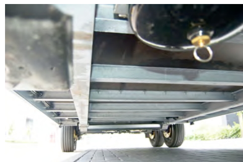
Alle kabels, remleidingen en componenten netjes onder het chassis opgeborgen, zodat deze niet beschadigt kunnen raken door obstakels.
