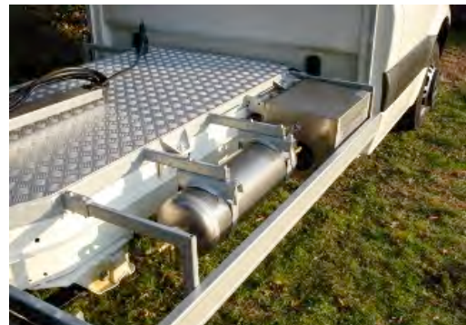
Het hulpframe tussen de cabine en de koppelschotel dicht gewerkt met aluminium tranenplaat.
