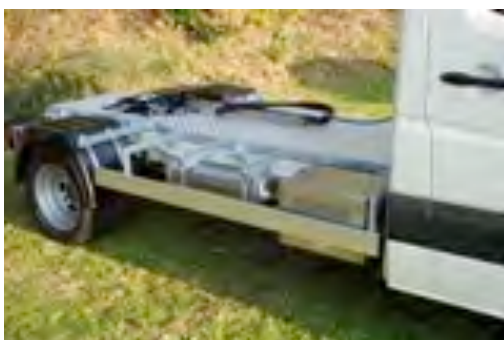
Aan de langsijde (zowel links als rechts) tussen de cabine en de spatborden een aluminium inrijdbeveiliging (plank) gemonteerd.
